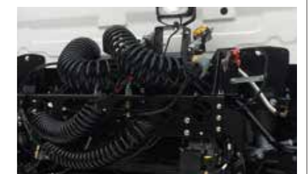
ジャンパーホース&ケーブル(コイル式) [ホイールベース(B尺)のみ標準装備です。]
