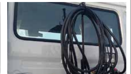
ジャンパーホース&ケーブル(ストレート式) [ホイールベース(D尺)以上は、標準装備です。]
