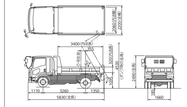
リヤゲート水平式ダンプ (新明和製) 諸元 No. ⑪
