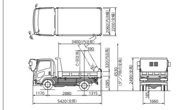
リヤゲート水平式ダンプ (新明和製) 諸元 No. ⑨⑩
